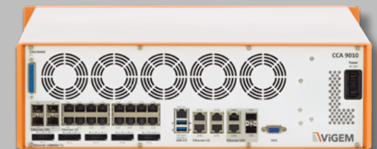
中档型号 CCA 9010-50 背面: 以高达 10 Gbit/s 速度连续记录。 Rear side of the mid-range model CCA 9010-50: Continuous data recording up to 10 Gbit/s.
